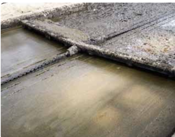
Figur 9.2 Skrabeanlægget er et af de tekniske anlæg, som kvægbryggerne er aller mest afhængige af. Det skal køre flere gange om dagen, hver dag, året rundt.
